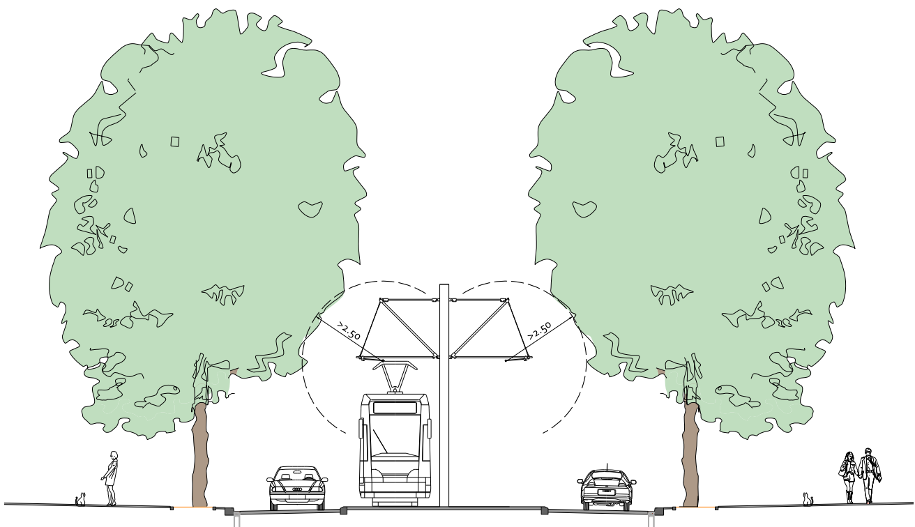
figuur 4.15 Profiel van vrije ruimte trambaan
